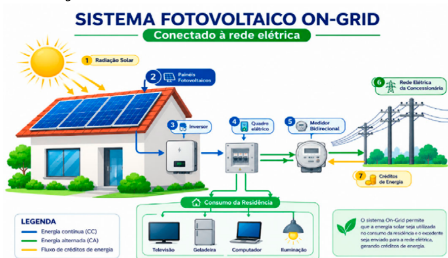
Figura 3 – Funcionamento de um sistema fotovoltaico On-Grid.
