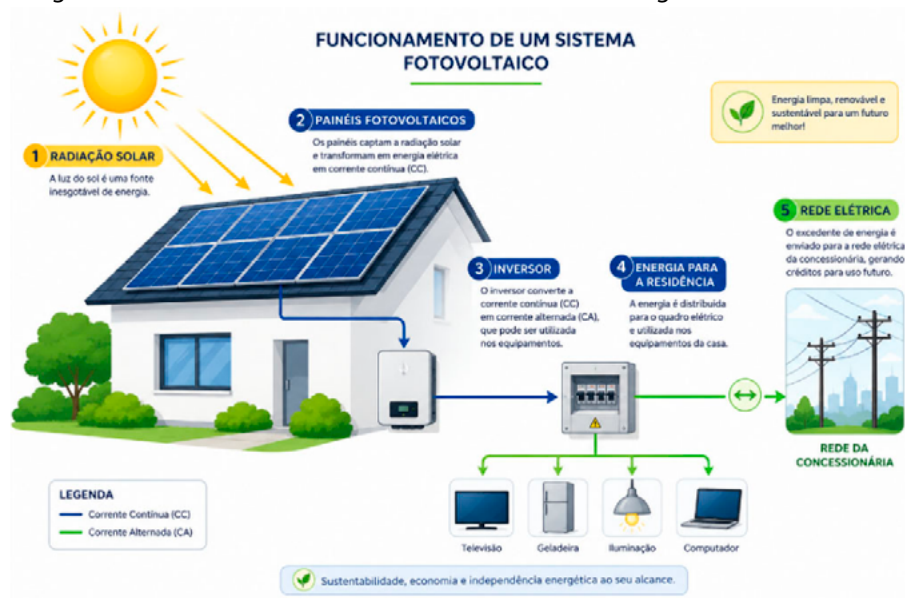
Figura 1 – Funcionamento básico de um sistema de energia solar fotovoltaica.
