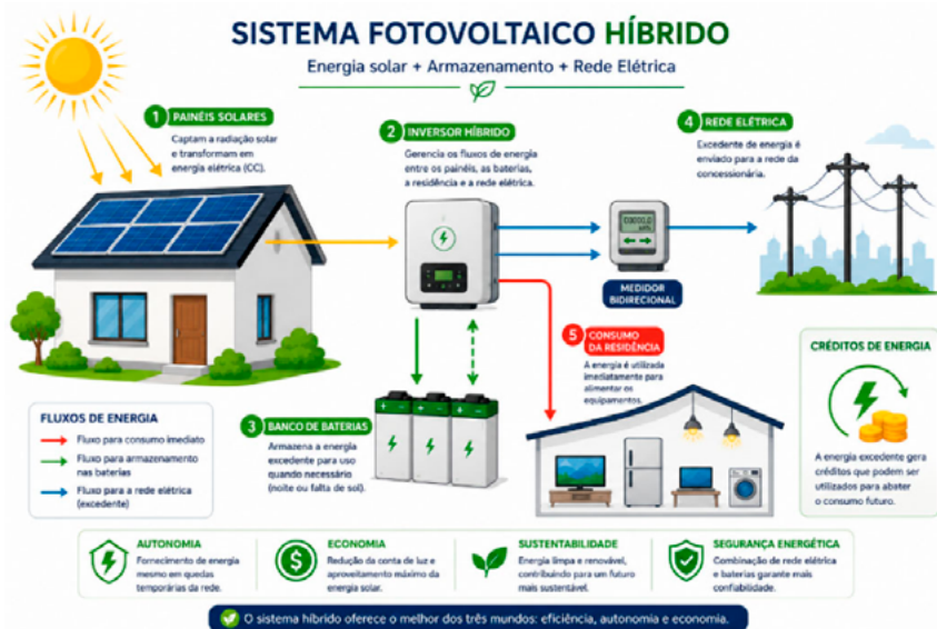
Figura 5 – Funcionamento de um sistema fotovoltaico híbrido.
